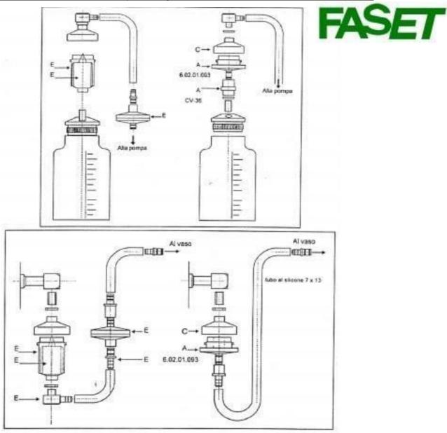
El nuevo filtro **Faset**, desarrolla la doble función de válvula de máximo lleno, protegiendo a la bomba de la penetración de líquidos, y de filtro de aire impidiendo el paso de bacterias, virus y cualquier partícula de dimensiones mayores o iguales a 0,10 mm.
